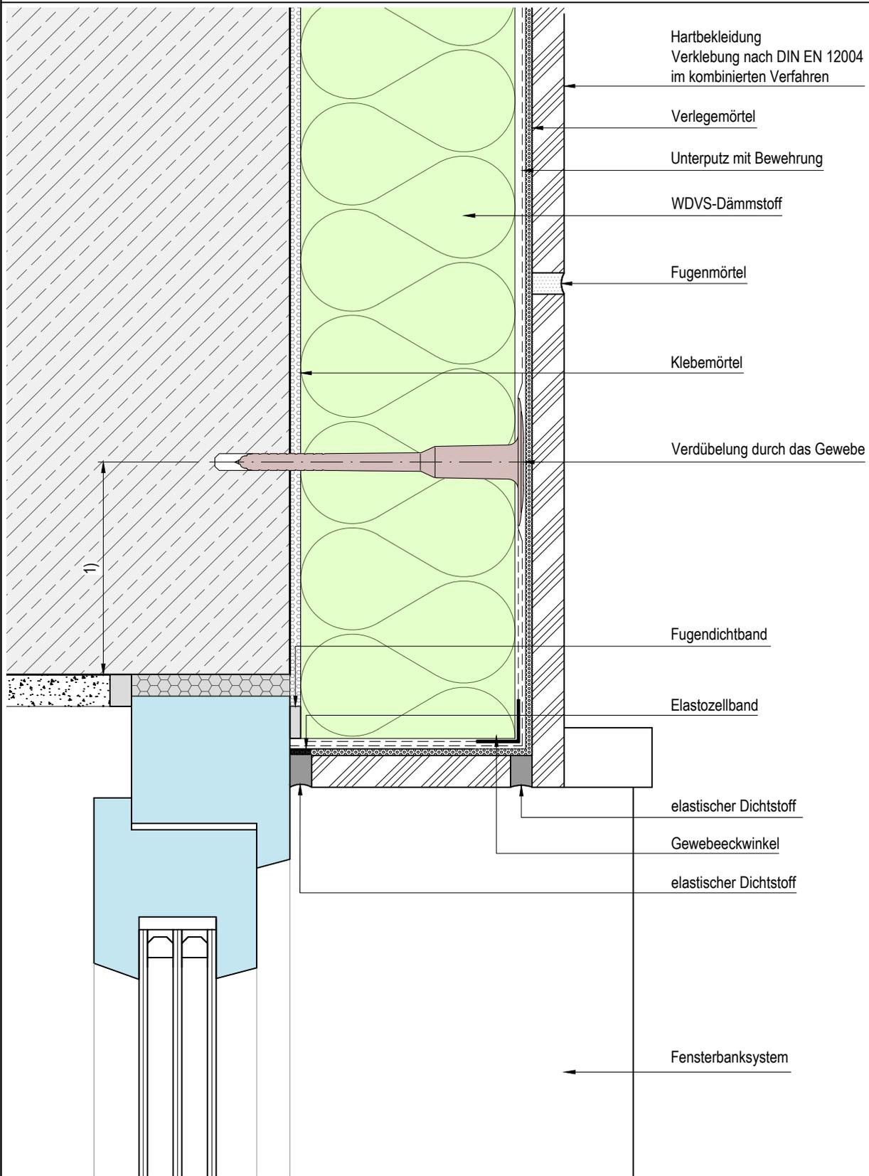
1) C<sub>min</sub> gemäß Dübelzulassung ≥ 10 cm
