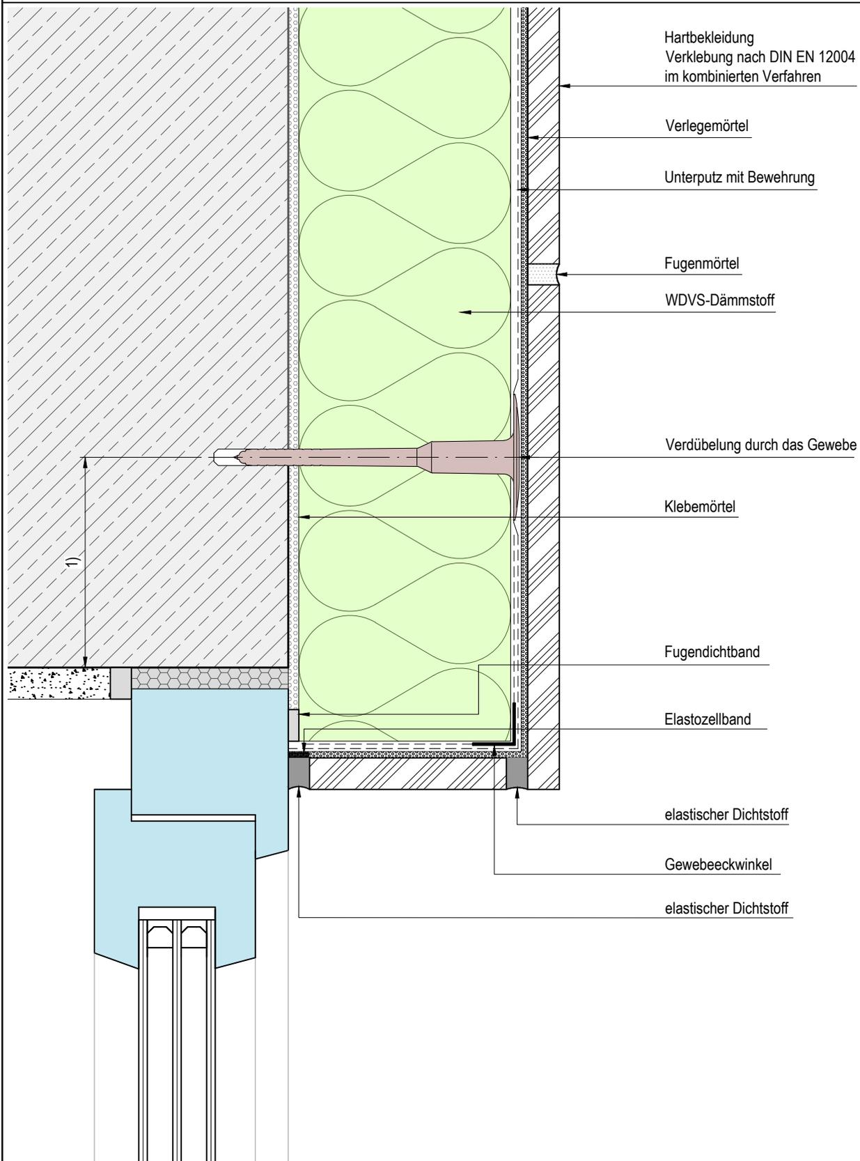
1)  $C_{min}$  gemäß Dübelzulassung  $\geq 10$  cm
