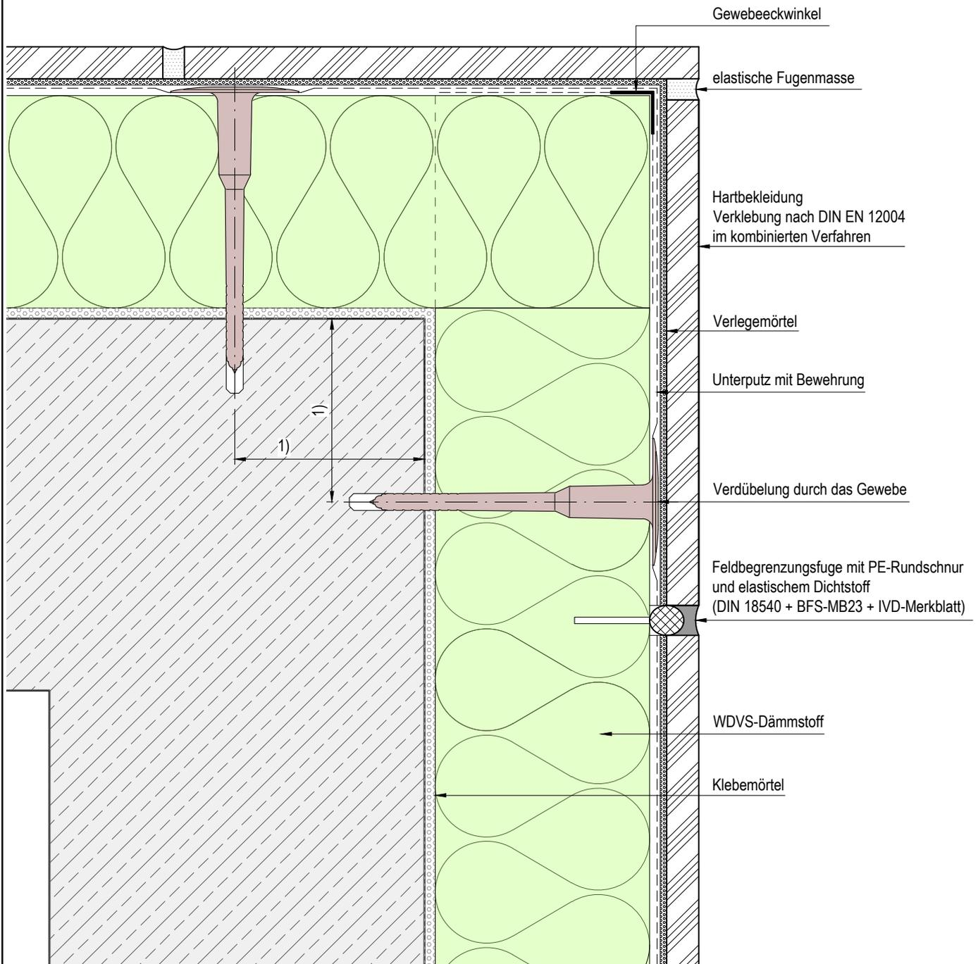
1)  $C_{min}$  gemäß Dübelzulassung  $\geq 10$  cm
