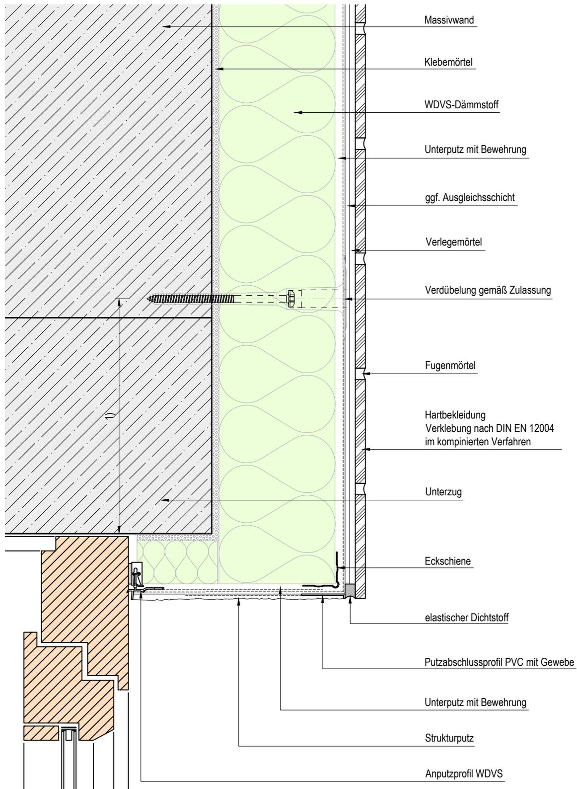
1)  $C_{min}$  gemäß Dübelzulassung
