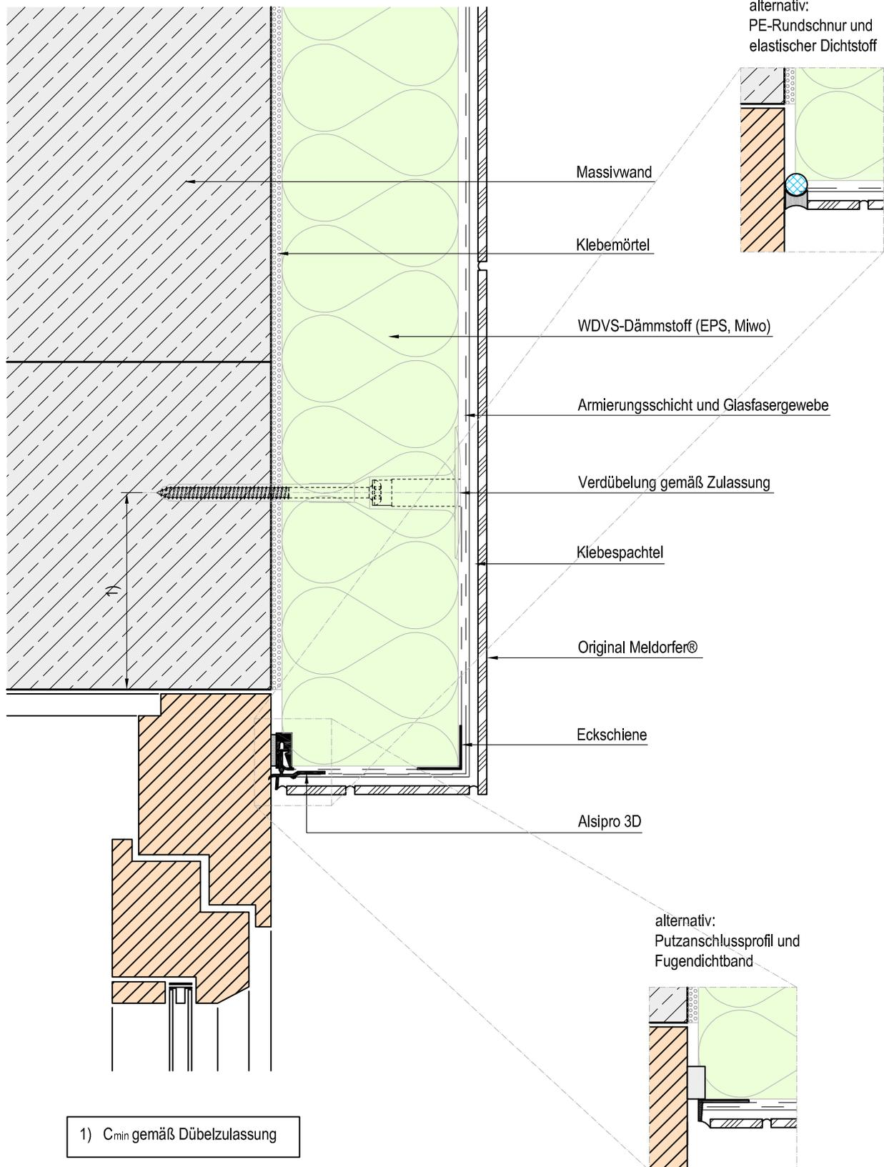
1)  $C_{min}$  gemäß Dübelzulassung
