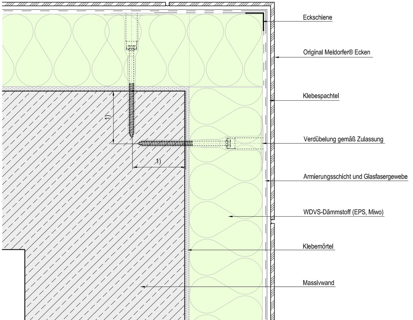
1)  $C_{\min}$  gemäß Dübelzulassung
