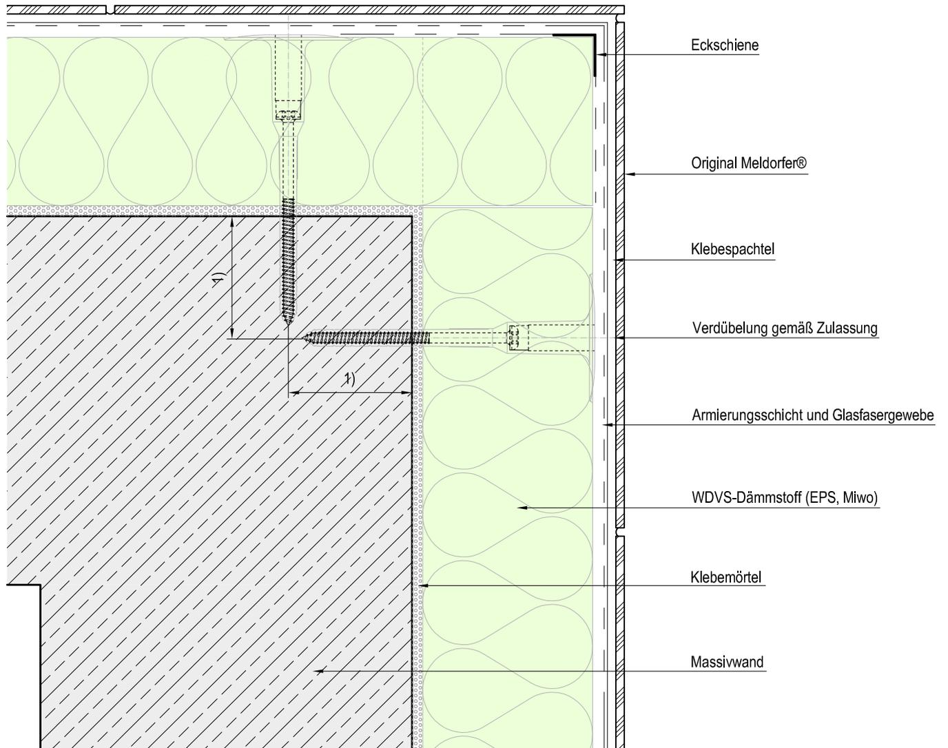
1)  $C_{min}$  gemäß Dübelzulassung
