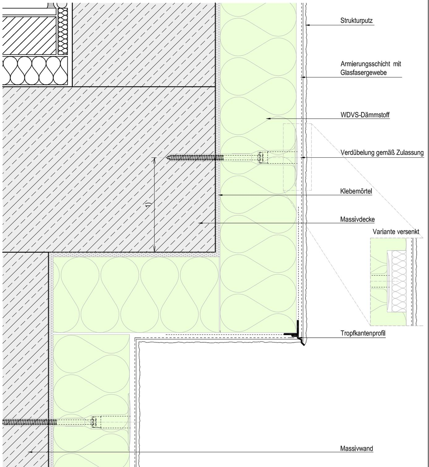
1)  $C_{min}$  gemäß Dübelzulassung
