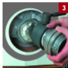
Aufschrauben des Anschlussventils
