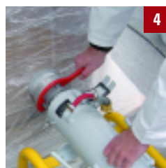
Festziehen der B-Kupplung
