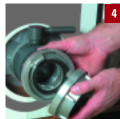
Öffnen der B-Kupplung
